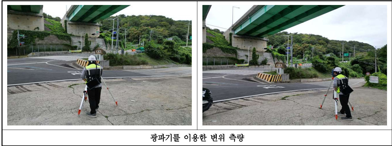
【표 19.3.16】 광파기를 이용한 측정 결과
